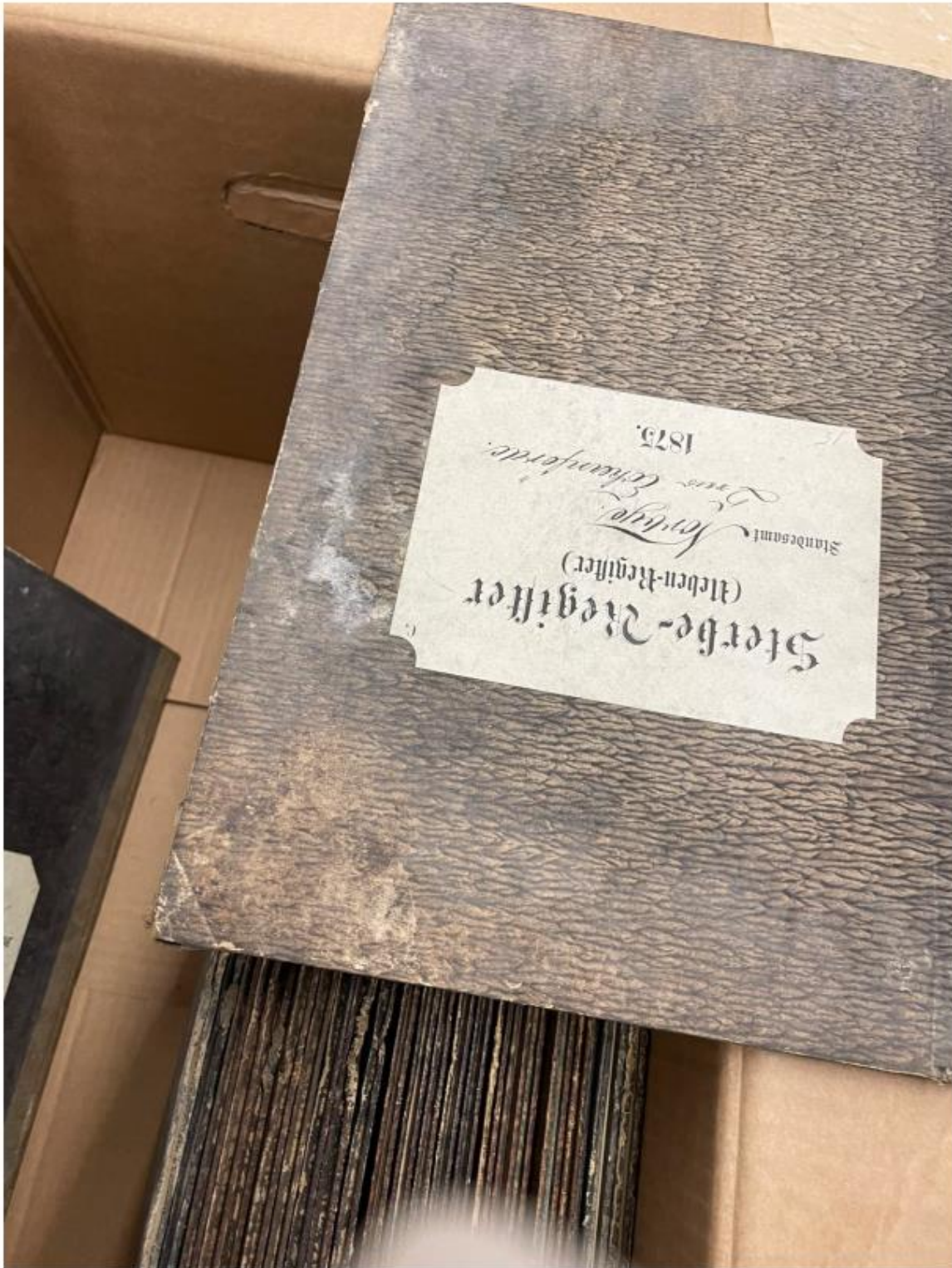
Abb. 12 mäßig verschimmelte Akte Schadensklasse 2 außen
