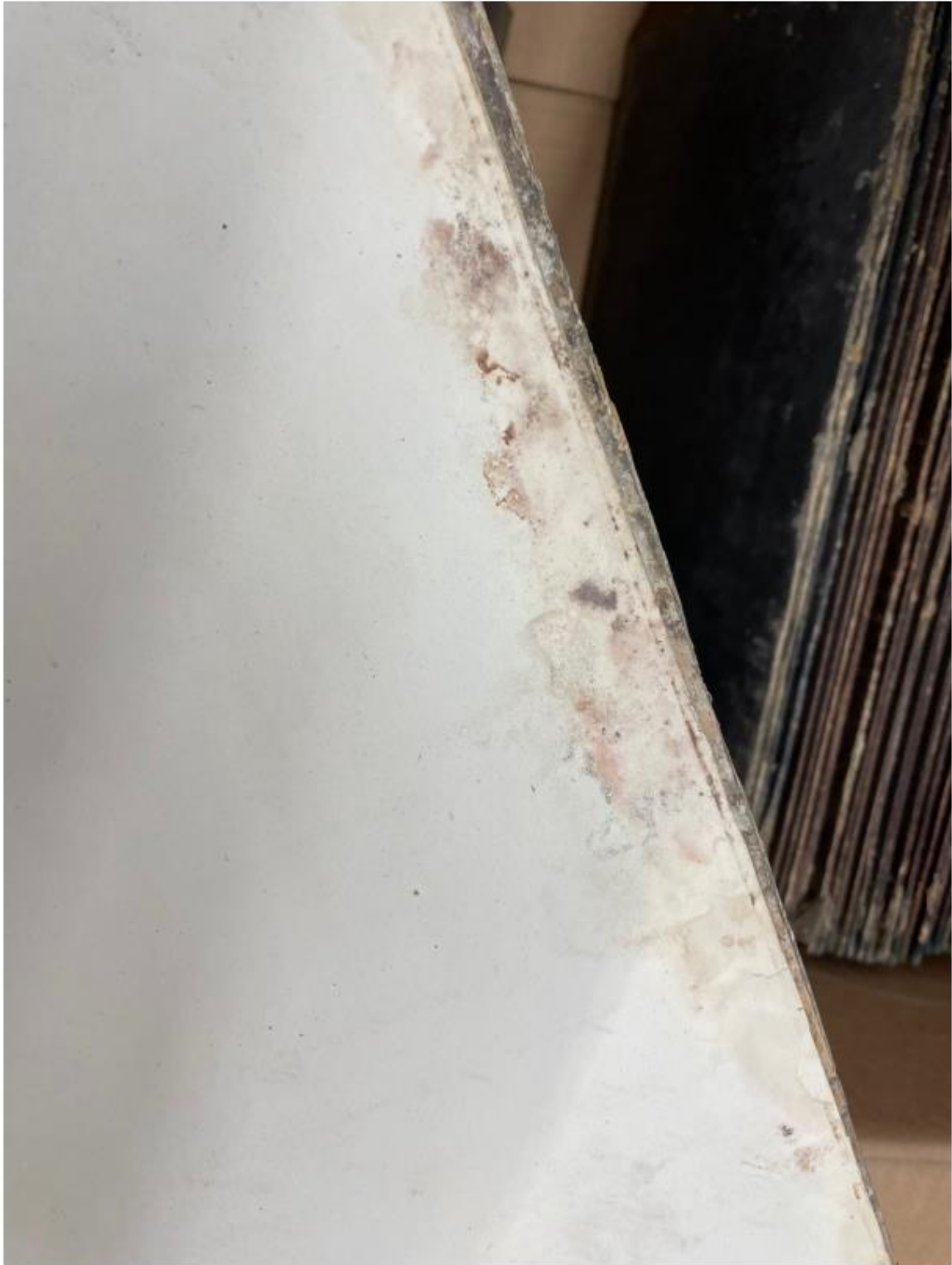
Abb. 11 Beschädigte Akte Schadensklasse 2 innen (mäßiger Schimmelbefall durch Wasserschaden)
