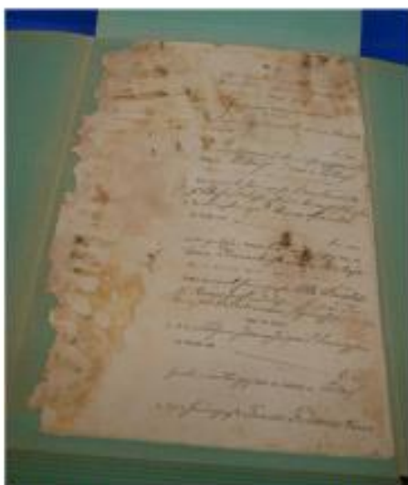
Abbildung 3: Register Norby, 1874. Das Dokument zeigt deutliche Spuren eines Schimmelbefalls: Schwemmränder mit abgebauter Papiersubstanz, Verfärbungen und aufliegender Schimmel.
