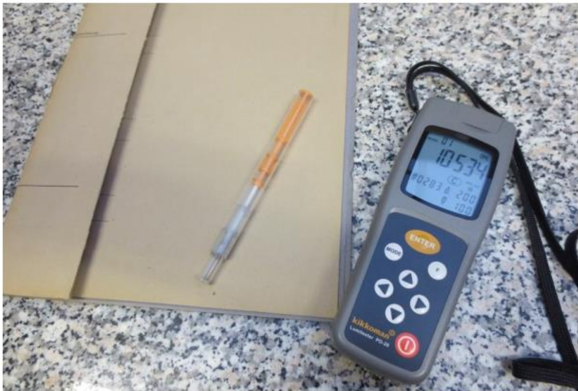
Abb. 1 ATP/AMP Messung mittels Messstäbchen
