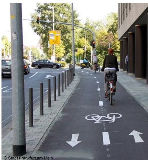
Straßenbegleitender Radweg Zweirichtungsverkehr
