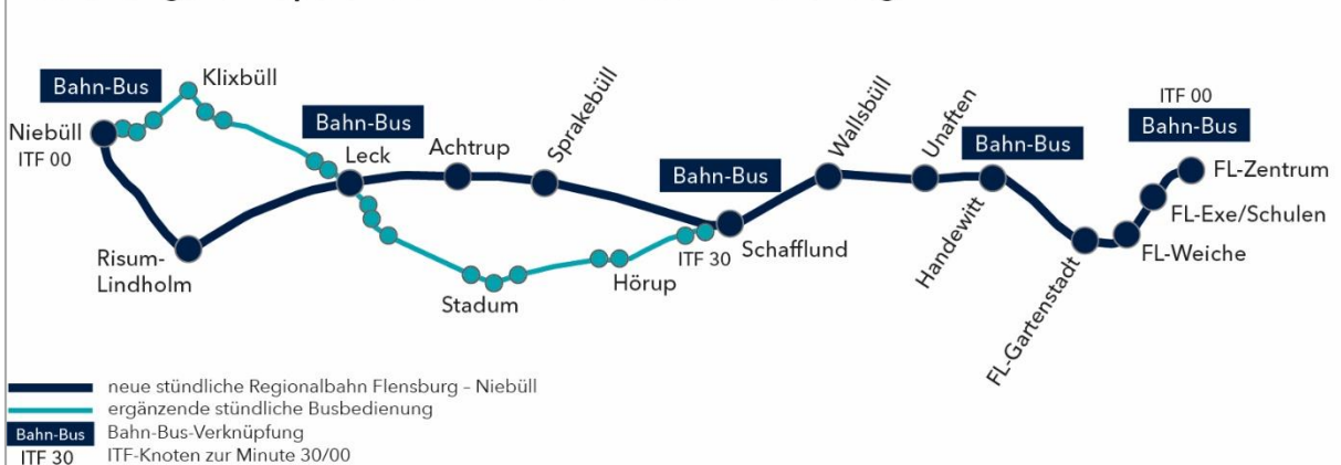
Abbildung 8: Bedienungskonzept für den Korridor Niebüll-Flensburg
