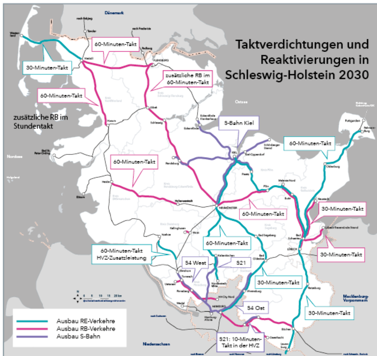
Abbildung 3: Mögliche Taktverdichtungen bis 2030 oder später
