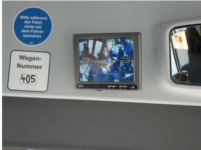
Abb. 13: Bildschirmübertragung des Fahrgastraumes am Fahrerplatz (Autokraft-Bus)
