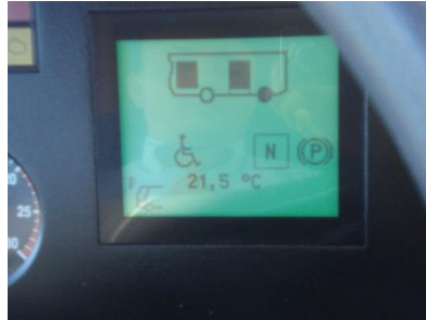
Abb. 14: Absenkwunschanzeige (Rollstuhlsymbol links unten) beim Fahrer (Autokraft-Bus)
