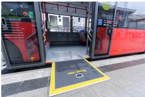
neben der Abb. 6: Mehrzweckfläche neben der 2. Tür; 2 Klappsitze, kontrastreiche Haltemöglichkeiten und Absatzmarkierungen (Niederflur-Gelenkwagen der KVG)
