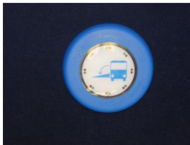
Abb. 8: Absenkwunschtaster innen (Autokraft-Bus)
