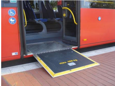
Abb. 1: ausgeklappte Rampe, Piktogramme (links) und Türöffner (rechts) an 2. Tür
