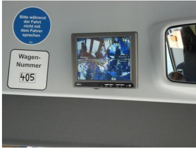
Abb. 13: Bildschirmübertragung des Fahrgastraumes am Fahrerplatz (Autokraft-Bus)
