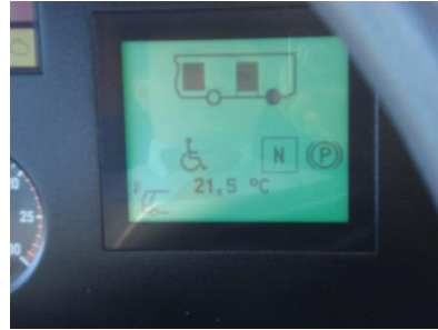
Abb. 14: Absenkwunschanzeige (Rollstuhlsymbol links unten) beim Fahrer (Autokraft-Bus)
