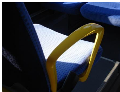
Abb. 11: Armlehne in kontrastreicher Farbgebung (Autokraft-Bus)
