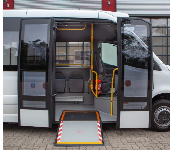
Abb. 26: Einstieg (vorne) mit ausgeklappter Rampe im Kleinbus
