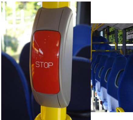
Abb. 16: Haltewunsch-taster Abb. 17/18: Haltestangen und Stufen/Absätze in kontrastreicher Farbgebung, mit Brailleschrift (oben) aber in Abb. 17 (links, Autokraft-Low-Entry-Wagen) viele Sitze ohne Haltestangen, nur mit – kontrastarmem – Haltegriff; Abb.18 Autokraft-NF-Gelenkbus
