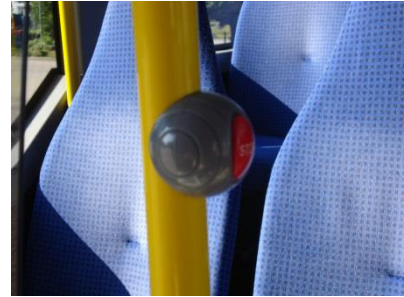
Abb. 15: Erhabener Haltewunsch-taster (Autokraft-Bus)
