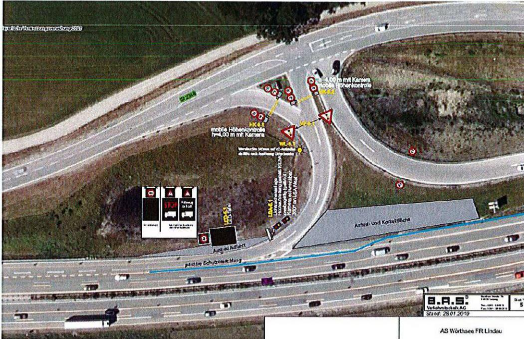
Bild 12: Mobile Vorhöhenkontrolle AS Würthsee
