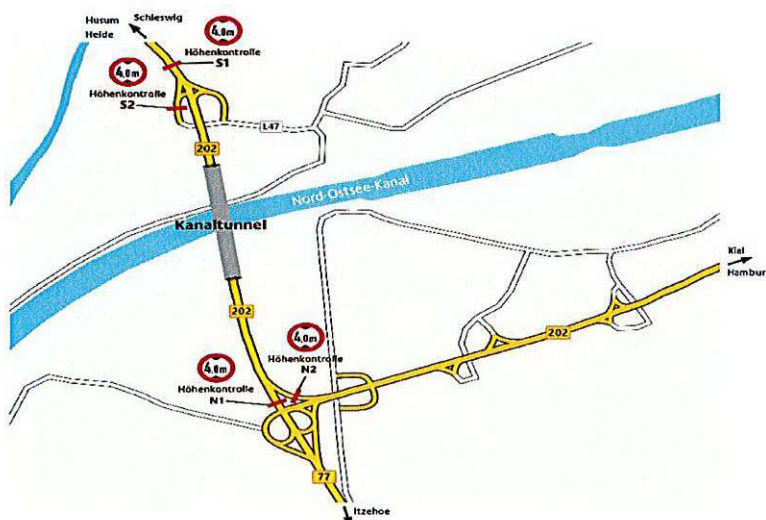
Bild 4: Positionen der Höhenkontrolle
