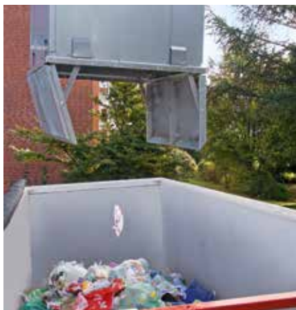
Leerung eines Unterflurbehälters über eine Ladefläche
