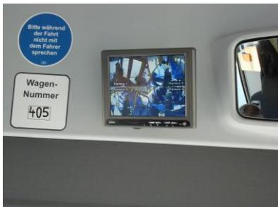
Abb. 13: Bildschirmübertragung des Fahrgastraumes am Fahrerplatz (Autokraft-Bus)
