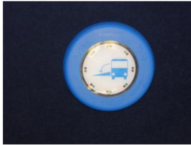
Abb. 8: Absenkwunschschalter innen (Autokraft-Bus)
