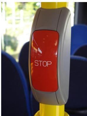
Abb. 16: Haltewunschschalter mit Brailleschrift (oben) (Autokraft-NF-Gelenkbus)
