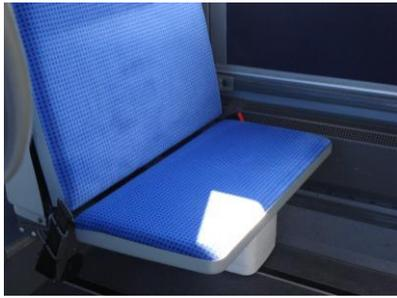
Abb. 7: ausgeklappter Klappsitz (Autokraft-Low-Entry-Bus)
