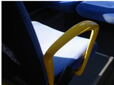
Abb. 11: Armlehne in kontrastreicher Farbgebung (Autokraft-Bus)
