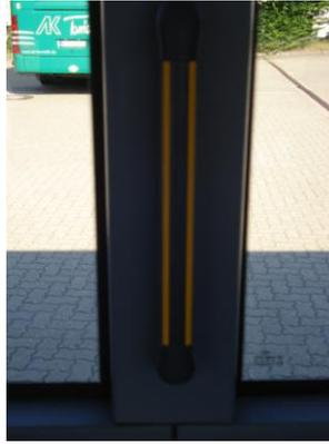
Abb. 20: markierte Haltemöglichkeit innen (Autokraft-Bus)
