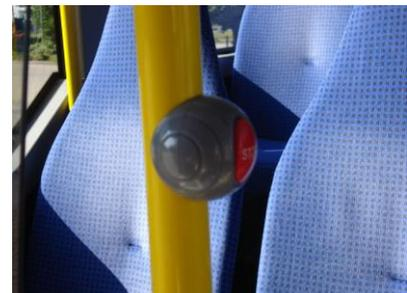
Abb. 15: Erhabener Haltewunschschalter (Autokraft-Bus)
