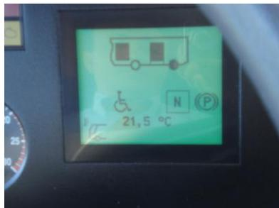
Abb. 14: Absenkwunschanzeige (Rollstuhlsymbol links unten) beim Fahrer (Autokraft-Bus)
