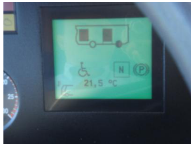
Abb. 14: Absenkwunsch-anzeige (Rollstuhlsymbol links unten) beim Fahrer (Autokraft-Bus)
