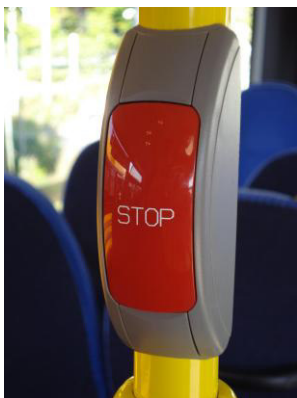
Abb. 16: Haltewunsch-taster mit Brailleschrift (oben) (Autokraft-NF-Gelenkbus)
