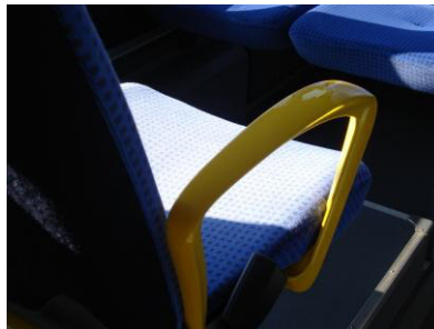
Abb. 11: Armlehne in kontrastreicher Farbgebung (Autokraft-Bus)
