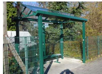
Abb. 40 (links)/ Abb. 41 (rechts): Hochwertige Fahrgastunterstände in Eckernförde (Abb. 40) und Krons-hagen (Abb. 41) – Markierung der Scheiben hier schwer erkennbar; zu beachten ist in Abb. 40 die Lücke der Sitzbänke unter dem Info-Aushang für Rollstuhl- und Rollatornutzer
