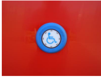
Abb. 2: Türöffner an 2. Tür (Zugang mit Klapprampe)
