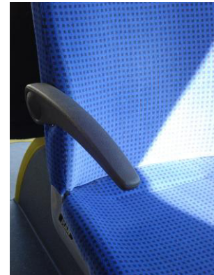
Abb. 12: klappbare Armlehne (Autokraft-Bus)
