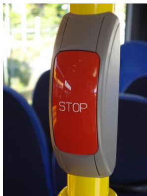
Abb. 16: Halteknopf mit Brailleschrift (oben) (Autokraft-NF-Gelenkbus)
