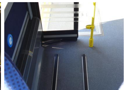
Abb. 6: Mehrzweckfläche neben der 2. Tür; erschwerte Zugänglichkeit durch Innenschwingtür und Trennscheibe; Halтанforderungstaster links (Low-Entry-Wagen, Autokraft)
