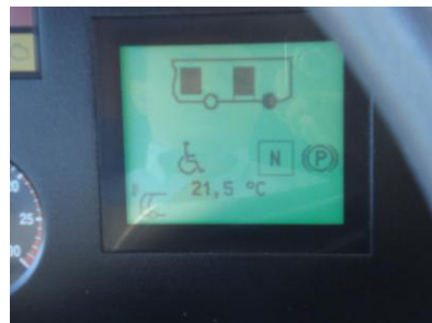
Abb. 14: Absenkwunsch-anzeige (Rollstuhlsymbol links unten) beim Fahrer (Autokraft-Bus)
