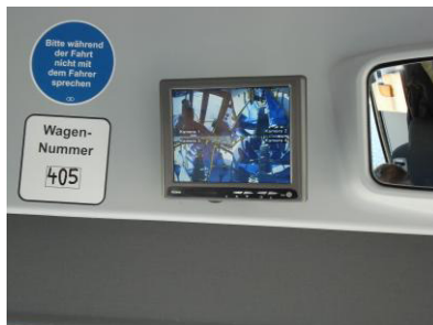
Abb. 13: Bildschirmübertragung des Fahrgastraumes am Fahrerplatz (Autokraft-Bus)
