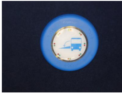
Abb. 8: Absenkwunsch-taster innen (Autokraft-Bus)
