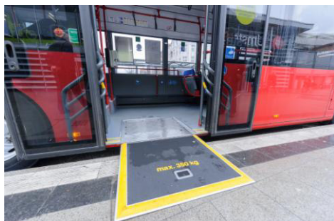
Abb. 4: Außenschwingtür und großzügige Mehrzweckfläche gegenüber (Niederflur-Gelenkwagen der KVG)
