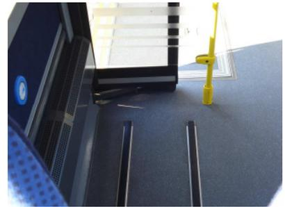
**Abb. 6:** Mehrzweckfläche neben der 2. Tür; erschwerte Zugänglichkeit durch Innenschwingtür und Trennscheibe; Halteanforderungstaster links (Low-Entry-Wagen, Autokraft)
